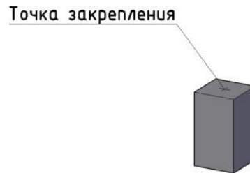
Рисунок 8.2.3 – Пример выполнения знака закрепления строительных осей
