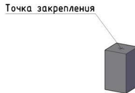
Рисунок 8.3 – Пример выполнения знака закрепления строительных осей
